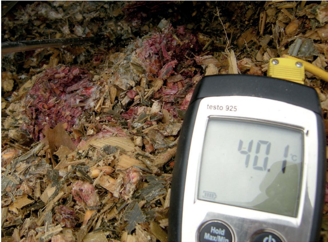
**Foto 1.** L'innalzamento della temperatura nelle zone periferiche è una buona indicazione di attività ossidativa ad opera di microrganismi aerobi.
